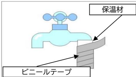
屋外に露出している水道管には布類・発泡スチロール等を保温材として巻き付けて濡れないようにビニールテープなどで保護しましょう。
