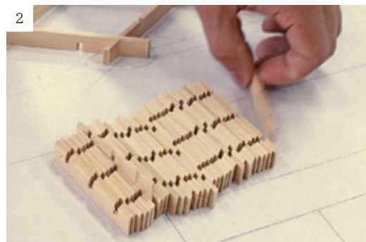
1. 特殊なカンナを使用して組子のパーツを切り出す 2. パーツは0.1ミリでも狂うと合わなくなる。斜めの切り込みも手仕事で。 3. 地組にパーツをはめ込む 4. 伝統的な意匠「菱田の字組み」。欄間(らんま)などに使われる。
