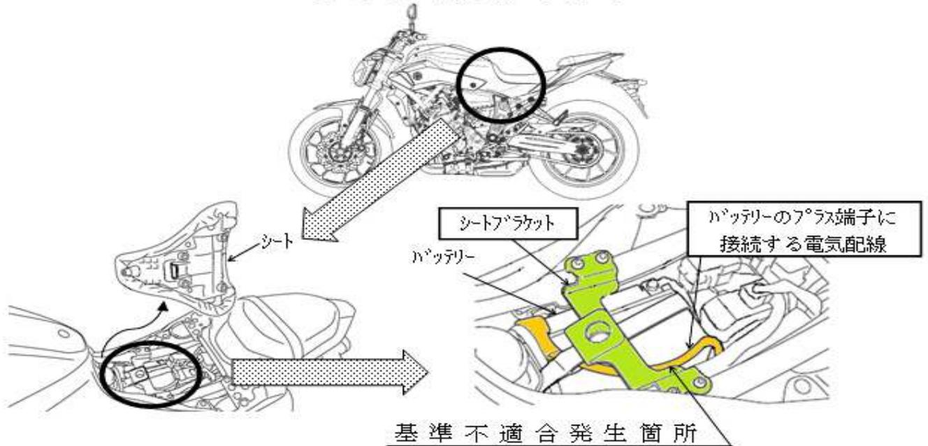
バッテリーのプラス端子に接続する電気配線の長さ及びシートブラケットの形状が不適切なため、電気配線がシートブラケットの上に乗り上げ、シートとシートブラケットの間に挟まることがある。そのため、そのままの状態で使用を続けると、当該電気配線の被覆が損傷し短絡して、最悪の場合、火災に至るおそれがある。
